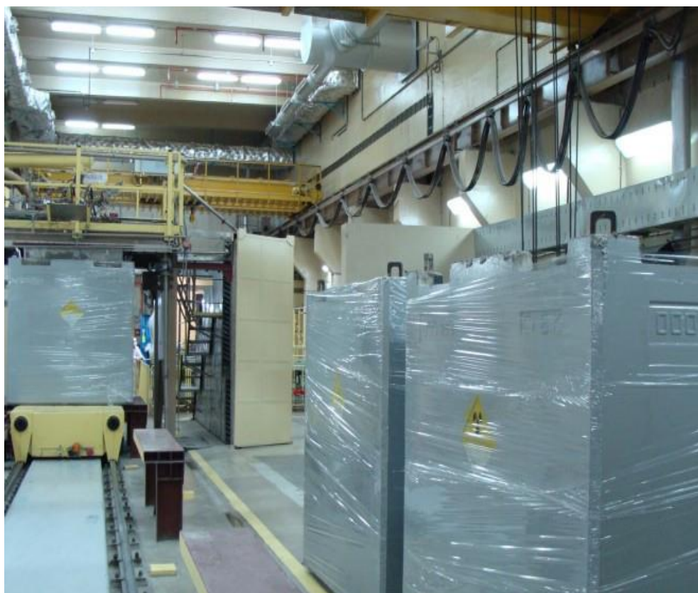
Фигура 7: Транспорт на стоманобетонери контейнери
