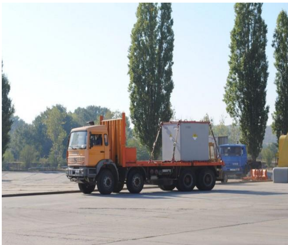
Фигура 8: Транспорт на Стоманобетонери контейнер
