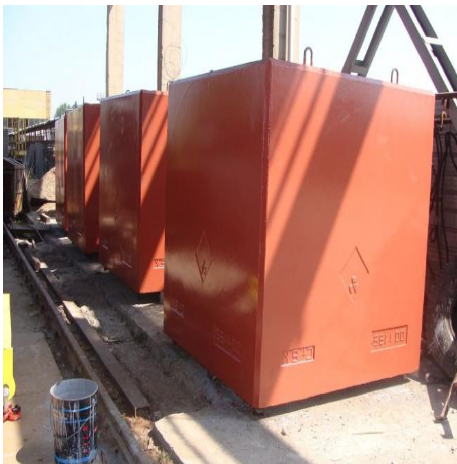
Фигура 5: Стоманобетонов контейнер- общ изглед
