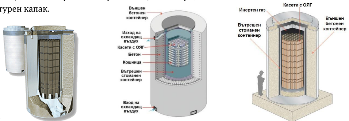
Фиг. 6. Общ вид и основни елементи на вертикален бетонен контейнер за сухо съхранение на ОЯГ
