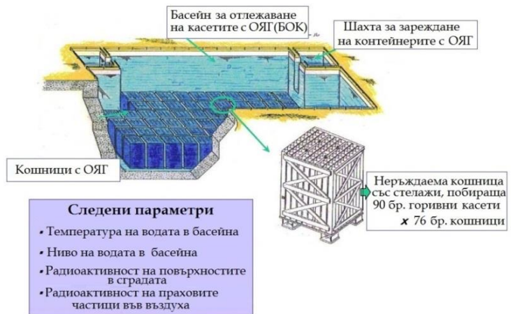
Фиг. 3. Общ вид, основни елементи и следени параметри на басейн за отлежаване на касети с отработено ядрено гориво при реактора
