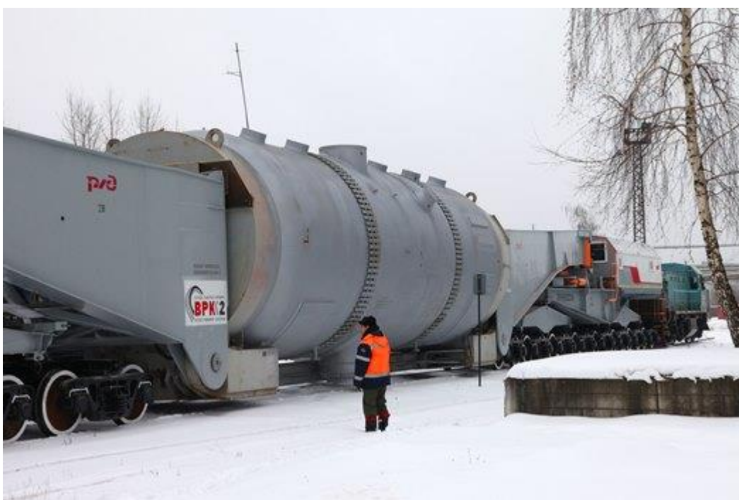
Напускане на завода производител (хоризонтален парогенератор)
