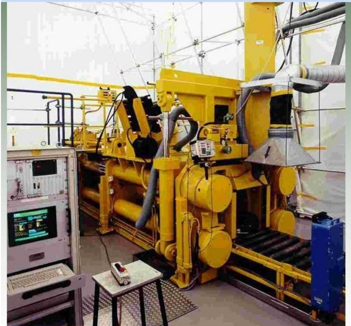
Фиг.6 Машина за пресоване на твърди радиоактивни отпадъци
