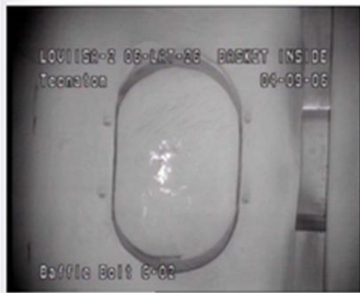
Фиг. 4.3.4 След подмяна на болтовете
