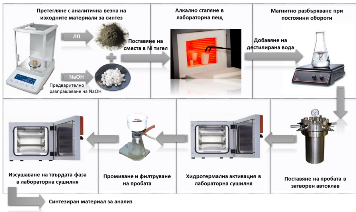
Фиг. 2 Технологична последователност на синтеза.
